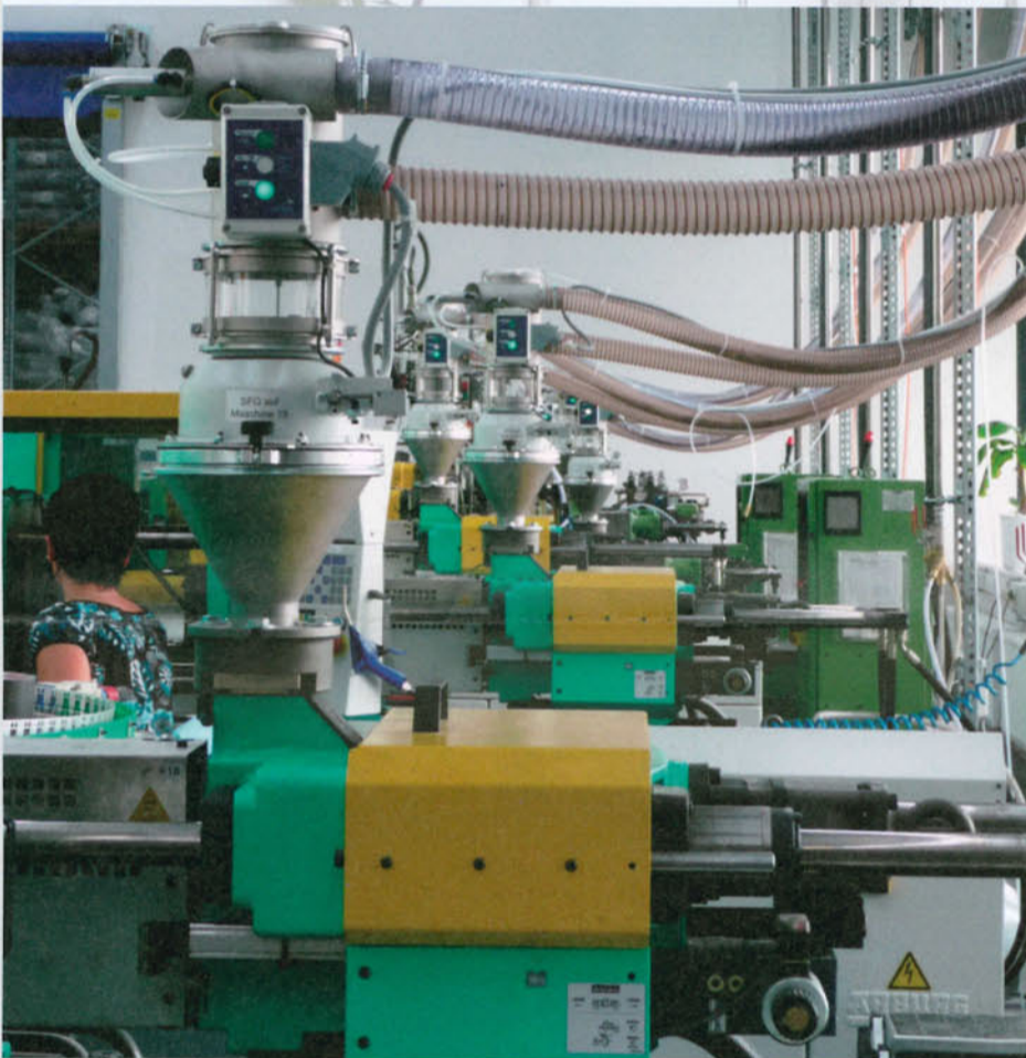
Die METRO Glasförderergeräte gewährleisten kleine Fördermengen und geringe Materialbevorratung auf den Maschinen
