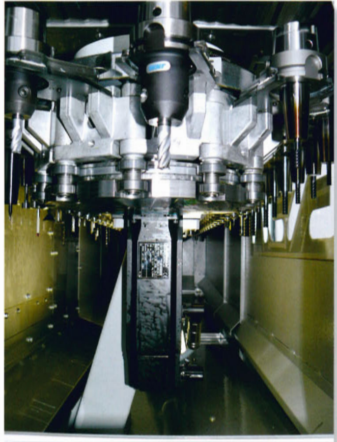
Bild 2: Der Werkzeugspeicher ist mit 80 Plätzen ausgerüstet. Für die optional zur Verfügung stehenden 200 Speicherplätze war der Platz nicht da
